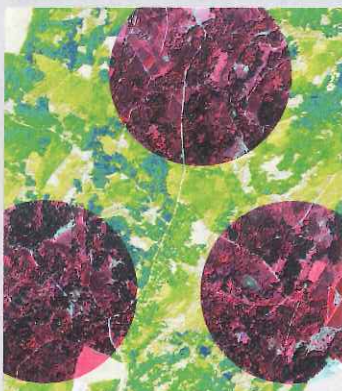
Vegetationshöhenmodell (Farbskala von weiss = 0 m bis dunkel- blau = 35 m) mit eingepassten Aus- schnitten aus dem FIR-Orthobild.
