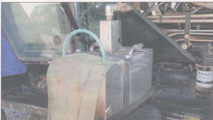
Le dispositif Vulcano comprend 3 éléments: un bulleur, un réacteur «pantone» et un diffuseur. Par dépression, un mélange d'eau et d'air est aspiré dans le bulleur pour y être dynamisé par le réacteur et ensuite réinjecté dans l'arrivée d'air. La combustion en est sensiblement améliorée et la consommation diminuée. Quand un moteur fonctionne à l'huile, le système assure son préchauffage (50-55°C) de sorte que les problèmes d'encrassement sont inexistantes.
