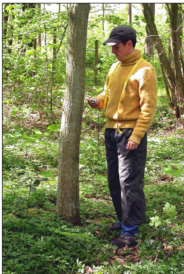
Figure 8. – Vérification de l'appartenance d'un arbre à la placette à l'aide d'un dendromètre Vertex.
