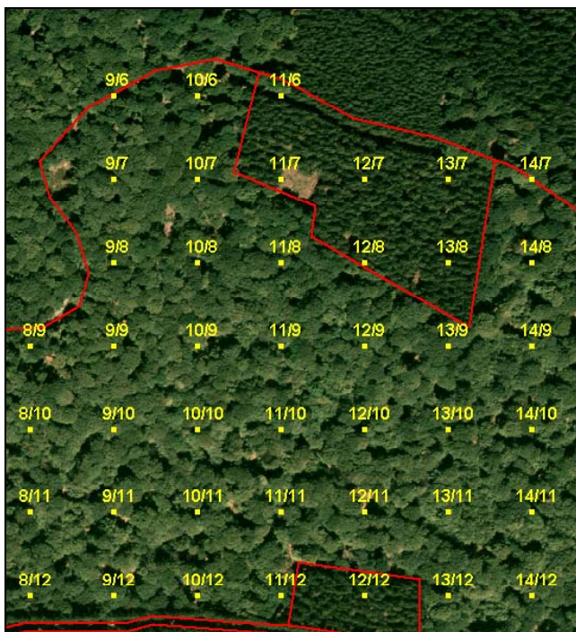
Figure 10. - Extrait d'une carte utilisée pour la localisation des placettes sur le terrain : représentation d'un orthophotoplan, du fond de carte topographique, des limites de la zone à inventorier et de la grille d'échantillonnage.
