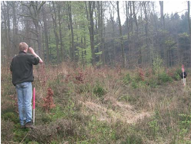
L'opérateur 2 mesure l'azimut de la direction P 0 -P 1 .
