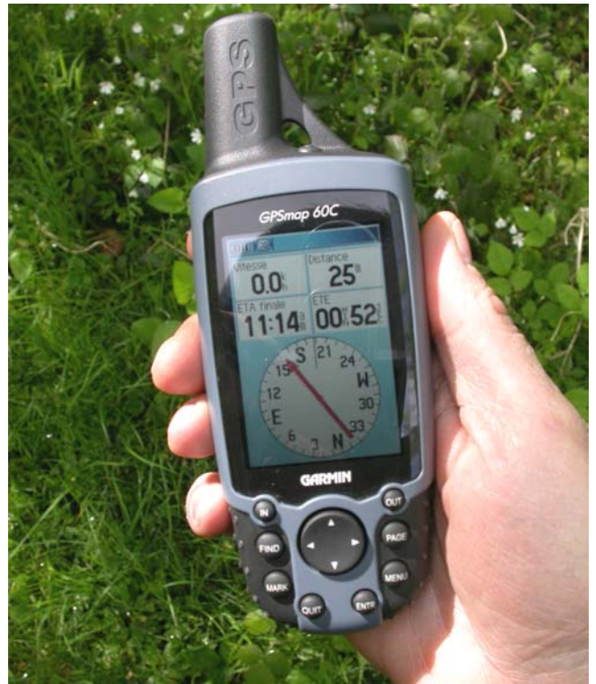
Figure 9. - Utilisation d'un GPS de « randonnée » (modèle Garmin GPSmap 60C) pour le cheminement vers les centres d'UE (distance restant à parcourir : 25 m, la flèche indique la direction à suivre).
